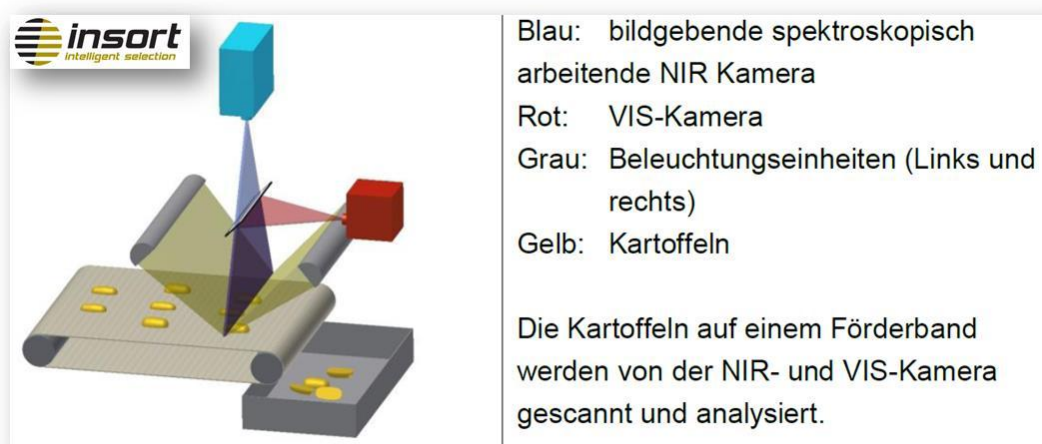
Abb. 6.2.1: Prinzip der bildgebenden Spektroskopie ( hyperspectral imaging ) (INSORT, 2015)
